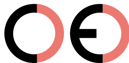
Falsche CE-Kennzeichnung (zu großer Zwischenraum)
